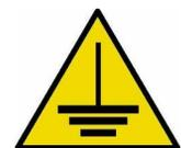
Die Anlage muss an den Erdungskreislauf angeschlossen werden, wobei die vom Hersteller vorgesehene entsprechende Klemme zu verwenden ist; dies muss vor dem ersten Anlegen der Spannung erfolgen.
